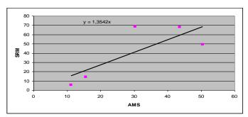
Test 1 : Ecart-type des différences entre les points et la fonction d'étalonnage trop grand
