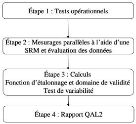
A l'aide des 15 mesurages parallèles (ou 5 dans certains cas), on déterminera la fonction d'étalonnage et son domaine de validité :
