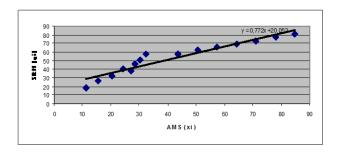
Le domaine de validité de la fonction d'étalonnage de l'AMS est alors [0 ; 1,1\*y<sub>s,max</sub>] avec y<sub>s,max</sub>, la valeur maximale mesurée par la SRM (Organisme de Contrôle), modélisée et normalisée.
